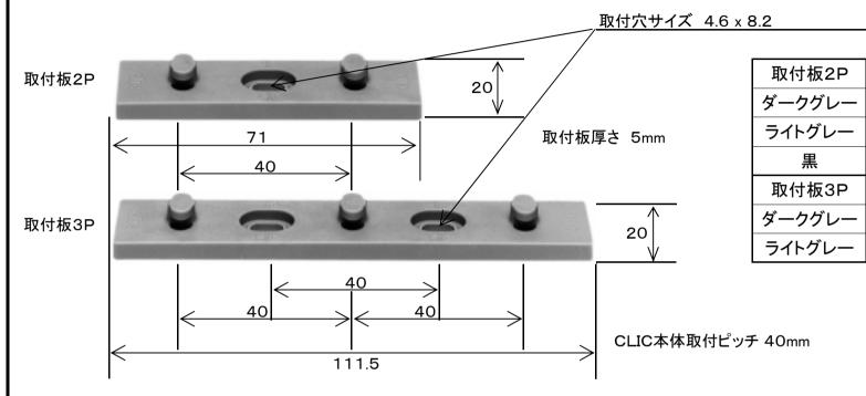
CLIC本体取付方法: CLIC本体底部の勘合部を取付板突起部と勘合させてCLIC本体を90° ひねることにより取り付ける
